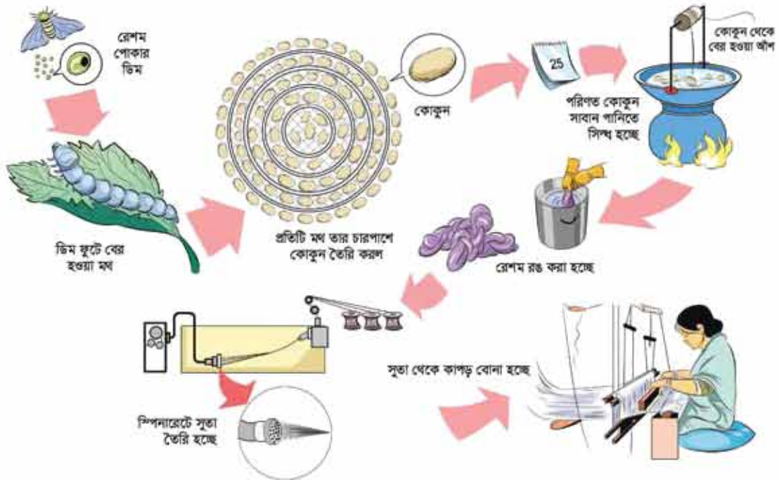
চিত্র ৬.০৪: রেশম তন্তু থেকে সূতা তৈরি
