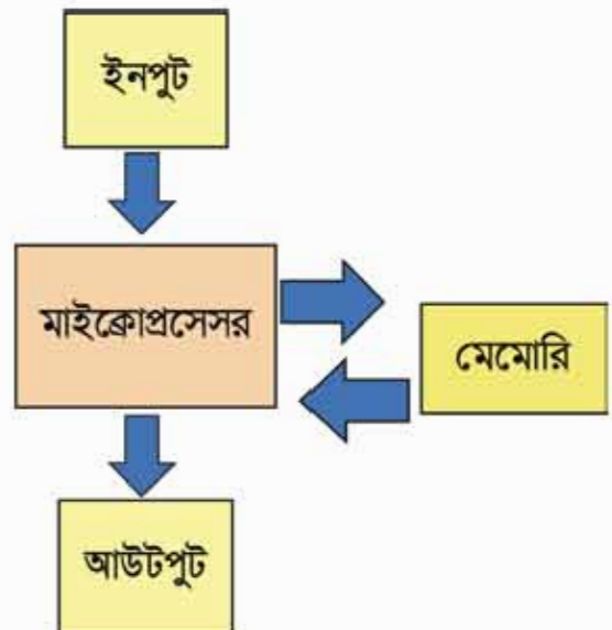
চিত্র ১৩.১৩: একটি কম্পিউটারের মূল অংশগুলো
