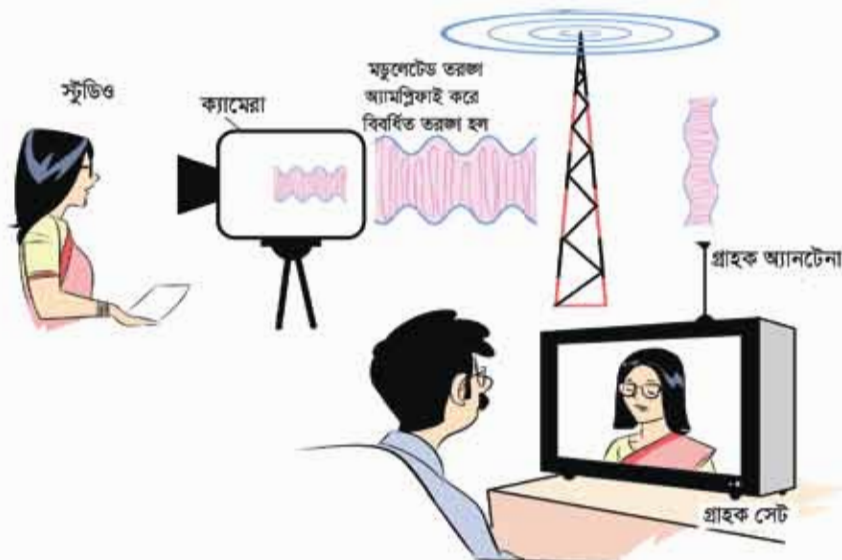
চিত্র ১৩.০৯: টেলিভিশন সম্প্রচার প্রক্রিয়া
