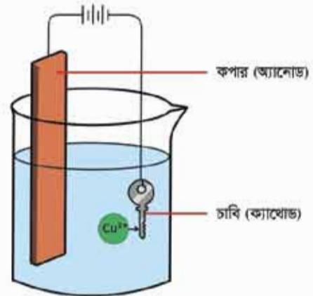
চিত্র 10.11: চাবির উপর কপার ধাতুর ইলেকট্রোপ্লেটিং।
